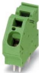
Клеммы для печатной платы, номинальный ток: 76 А, номинальное напряжение: 400 В, размер шага: 10 мм, полюсов: 1, тип подключения: Пружинный зажим, монтаж: Пайка волной припоя, направление подключения, проводник/печатная плата: 45 °, цвет: зеленый. Возможна установка в ряд модулей с различным количеством полюсов (контактов)!
