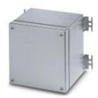
Клеммная коробка, комплектация фланцевыми пластинами внизу, татериал: Высококачественная сталь 304 / 1.4301, поверхностное сопротивление: сатинированный, серебристый, 450 мм х 620 мм х 160 мм, тип замка: навинчиваемая крышка, комплект поставки - ATD: Крепежный кронштейн в комплекте с винтами, Штифты заземления M12, расположенные снаружи, Инструкция по монтажу, Фланцевые пластины, Крепежный кронштейн в комплекте с винтами
