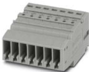
Соединитель COMBI, номинальное напряжение: 500 В, номинальный ток: 24 А, тип подключения: Зажимы Push-in, количество точек подсоединения: 7, полюсов: 7, сечение: 0,14 мм<sup>2</sup> - 4 мм<sup>2</sup>, AWG: 26 - 12, ширина: 36 мм, высота: 41 мм, цвет: серый
