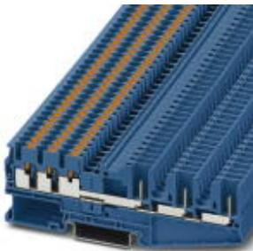
Проходные клеммы, номинальное напряжение: 500 В, номинальный ток: 24 А, тип подключения: Разъемное подключение / Push-in, количество точек подсоединения: 6, сечение: 0,14 мм<sup>2</sup> - 4 мм<sup>2</sup>, AWG: 26 - 12, ширина: 5,2 мм, высота: 35,3 мм, цвет: синий, тип монтажа: NS 35/7,5, NS 35/15
