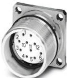
Приборный соединитель, передняя часть стенки, прямой, экранирован.: есть, для стандартной блокировки и SPEEDCON, M23, Полосов: 16, тип контактов: Розетка, Выводы под пайку, Плоское уплотнение, 4x Ø 3,2, размер фланца: 25 мм x 25 мм
