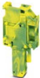
Штекер, номинальное напряжение: 800 В, номинальный ток: 32 А, тип подключения: Винтовые зажимы, количество точек подсоединения: 1, полюсов: 1, сечение: 0,2 мм<sup>2</sup> - 6 мм<sup>2</sup>, AWG: 24 - 10, ширина: 6,2 мм, высота: 41,2 мм, цвет: желто-зел.
