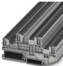
Двухъярусные клеммы, тип подключения: Зажимы Push-in, сечение: 0,14 мм<sup>2</sup> - 1,5 мм<sup>2</sup>, AWG: 26 - 14, ширина: 3,5 мм, цвет: серый, тип монтажа: NS 35/7,5, NS 35/15
