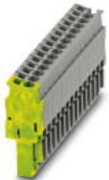
Штекер, номинальное напряжение: 500 В, номинальный ток: 24 А, тип подключения: Пружинный зажим, Штекерное подключение, количество точек подсоединения: 15, полюсов: 15, сечение: 0,08 мм<sup>2</sup> - 4 мм<sup>2</sup>, AWG: 28 - 12, ширина: 78 мм, высота: 39 мм, цвет: серый
