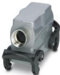
Сальниковый корпус HEAVYCON B16, с двумя защелками, высота 56 мм, с патрубком 1x M25, боковое подсоединение кабеля
