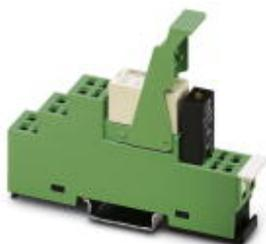
Предварительно смонтированный релейный модуль с пружинными зажимами, состоящий из: установочного блока (основания), вставного миниатюрного реле контроля мощности с силовыми контактами, вставного индикатора, вставного подавителя помех и выталкивателя реле. Входное напряжение: 230 В AC, контакты: 2 переключающих контакта, 8 А
