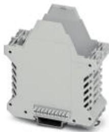
Установочный корпус, длина: 99 мм, с вентиляционными отверстиями, Нижняя часть корпуса, поперечное соединение: встроенный шинный соединитель, цвет: светло-серый, ширина: 45 мм, высота: 114,5 мм, кол-во контактов поперечного соединителя: 10
