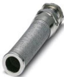
Кабельный ввод, материал резьбового соединения: латунь, никелированный, применение: Стандартн., наружный диаметр кабеля 9 мм ... 17 мм, экранировка: нет, резьба соединительной части: M25 x 1,5, цвет: серебристый, с защитой от излома, с уплотнительным кольцом
