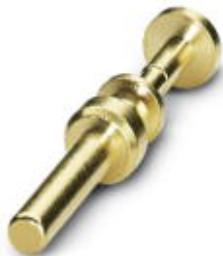
Обжимной контакт, с разворотом, Отдельный контакт, диаметр контакта: 3,6 мм, диапазон обжима: 1 мм<sup>2</sup> ... 2,5 мм<sup>2</sup>
