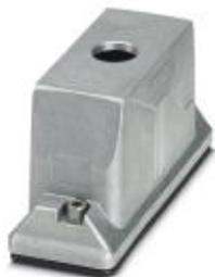
Сальниковый корпус HEAVYCON ADVANCE B24, с винтовым зажимом (внутренний шестигранник) из нержавеющей стали, стойкий к воздействию морской воды алюминий, высота 74 мм, с резьбой, 1x M25, прямой кабельный отвод, без покрытия; проводящее уплотнение (свойства ЭМС)
