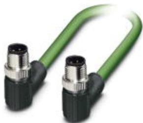
Сетевой кабель, PROFINET CAT5 (100 Мбит/с), 4-полюсн., PUR без галогенов, зеленый RAL 6018, экранирован., Штекеры угловой M12 SPEEDCON / IP67, механические ключи: D, к Штекеры угловой M12 SPEEDCON / IP67, механические ключи: D, длина кабеля: 2 м
