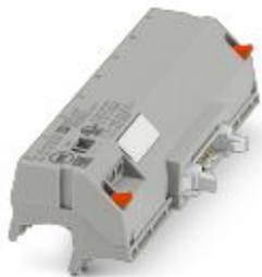
Адаптер V8 для 8 x PLC-INTERFACE (14 мм), управление: Системная кабельная разводка выходных плат ПЛК, Подключение 1: Винтовые зажимы 1x, Подключение 2: IDC/FLK штыревой разъем 1x 14-полюсн., Подключение 3: Штекерное подключение (возможна установка на 8 клеммах PLC-INTERFACE), количество каналов: 8, логич. схемы управления: подключение к положительному полюсу
