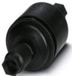
Корпус для защиты соединений сращиванием проводов солнечных коллекторов. Позволяет сращивание 3 проводников (1,5 до 25 мм<sup>2</sup>/16 до 4 по американскому сортаменту проводов макс.) в корпусе уровня IP67.
