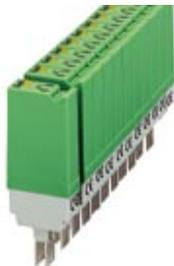
Вставное силовое полупроводниковое реле, со световым индикатором и защитной схемой во входной и выходной цепи, вход: 24 В пост. тока, выход: 3 - 30 В пост. тока/макс. 5 А, для вставки в базовые клеммные блоки
