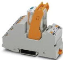
Предустановленный релейный модуль с разъемами push-in, состоящий из базового модуля, реле с силовыми контактами с дополнительным твердым позолоченным покрытием и держателя Исполнение контакта: 4 переключающих. Входное напряжение: 24 В пост. тока
