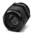
Кабельный ввод, материал резьбового соединения: РА, наружный диаметр кабеля 34 мм ... 44 мм, экранировка: нет, резьба соединительной части: Pg48, цвет: иссиня-чёрный RAL 9005
