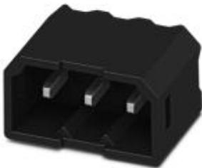
Корпусная часть для печатных плат, номинальный ток: 6 A, расчетное напряжение (III/2): 160 В, полюсов: 3, размер шага: 2,5 мм, цвет: черный, поверхность контакта: олово, монтаж: THR пайка
