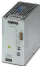
Источник питания QUINT POWER с регулировкой в первичной цепи для установки на несущую рейку, с регулируемыми выходными характеристиками и SFB Technology (Selective Fuse Breaking), защитное лаковое покрытие и встроенная развязка Mosfet, вход: 1-фазный, выход: 24 В DC / 20 А
