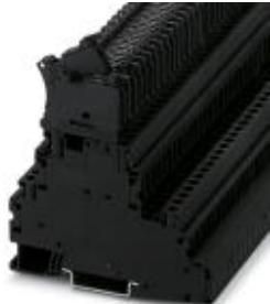
Клеммы для установки предохранителей, тип предохранителя: Стекло / керамика / ..., тип подключения: Винтовые зажимы, сечение: 0,14 мм<sup>2</sup>- 4 мм<sup>2</sup>, AWG: 26 - 10, номинальный ток: 30 A, номинальное напряжение: 60 В, ширина: 6,2 мм, тип предохранителей: G / 5 x 20, тип монтажа: NS 35/7,5, NS 35/15, цвет: черный
