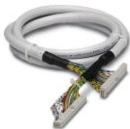
Подготовленный круглый кабель; Подключение 1: IDC/FLK коммутационная плата (1x 50-полюсн.); Подключение 2: IDC/FLK коммутационная плата (1x 50-полюсн.); длина кабеля: 1,25 м
