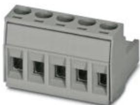
Разъемы для печатной платы, номинальный ток: 12 А, расчетное напряжение (III/2): 320 В, полюсов: 5, размер шага: 5,08 мм, тип подключения: Винтовой зажим с натяжной гильзой, цвет: сигнальный серый, поверхность контакта: олово
