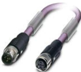
Системный кабель шины, PROFIBUS (12 Мбит/с), 2-полюсн., PUR без галогенов, фиолетовый RAL 4001, экранирован., Штекеры прямое M12 SPEEDCON, В-кодирование, к Гнездо прямое M12 SPEEDCON, В-кодирование, длина кабеля: 0,3 м
