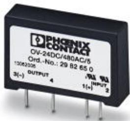
Полупроводниковое реле для усиления сигналов и гальванической развязки цепей управления и нагрузки, вставляется в штекерные основания SIM-AMS, закрепляемые методом пайки, в качестве варианта: с контактами для непосредственного монтажа на печатной плате, вход: 4 - 32 В DC, выход: 12-530 В AC / 5 А
