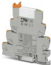
Интерфейсный блок PLC, состоит из базового клеммного модуля PLC-BPT.../21 с соединителем Push-in с вставным мини-реле с силовым контактом, установка на монтажную шину NS 35/7,5, 1 переключающий контакт, входное напряжение 120 В пер. тока / 110 В DC
