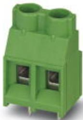
Клеммы для печатной платы, номинальный ток: 32 А, номинальное напряжение: 630 В, размер шага: 7,62 мм, полюсов: 2, тип подключения: Винтовой зажим с натяжной гильзой, монтаж: Пайка волной припоя, направление подключения, проводник/печатная плата: 0 °, цвет: кремнисто-серый
