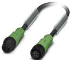
Кабель для датчика / исполнительного элемента, 3-полюсн., PUR без галогенов, темно-серый RAL 7021, Штекеры прямое M12, A-кодирование, к Гнездо прямое M12, A-кодирование, длина кабеля: 3 м, с пластмассовой накатанной гайкой
