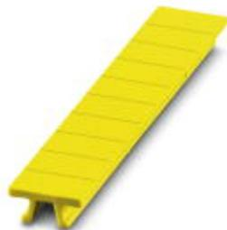
Планка Zack, возможен заказ: в лентах, желтый, надписи в соответствии с требованиями заказчика, тип монтажа: крепление в высоких пазах для табличек, для клемм шириной: 5,2 мм, размер маркировочного поля: 5,15 x 10,5 мм
