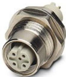
Встраиваемая гнездовая часть разъема для датчика / исполнительного элемента, 5 контактов, M12, с механическим ключом В-типа, монтаж с задней части стенки / винтовой монтаж с резьбой Pg9, защита от скручивания, с прямыми выводами под пайку
