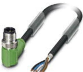
Кабель для датчика / исполнительного элемента, 5-полюсн., PUR без галогенов, темно-серый RAL 7021, экранирован., Штекеры угловой M12, А-кодирование, к свободный конец, длина кабеля: 3 м
