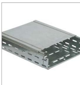
Лоток имеет замок (кроме горячеоцинкованного) круглой, травмобезопасной формы, который к тому же увеличивает механическую прочность лотка в сравнении с прямыми, беззамковыми лотками.
