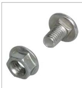
Для соединения кабельных лотков между собой и с аксессуарами используется универсальный соединительный комплект КС М6×10. Благодаря квадратному подголовнику, фиксирующему винт, для монтажа кабельной трассы потребуется только один ключ на 10 мм.
