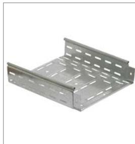
Развитая перфорация значительно снижает вес лотка, не изменяя его прочностные характеристики, и позволяет легко закреплять внутри лотка кабель при помощи нейлоновых стяжек.
