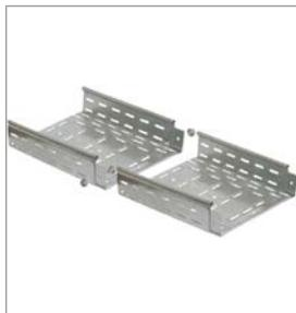
Лотки соединяются с помощью разъемов «мама-папа» и прочно фиксируются комплектом соединительным КС М6×10. Стандартная длина лотков – 3 метра.
