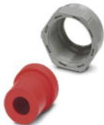
Резьбовой сальник Pg16 с частично нарезанной резьбой, пластмассовый, в комплекте с резиновым уплотнением с одним отверстием и прижимной винтовой деталью, для корпусов исполнения 1, кабель (мм) 9-13
