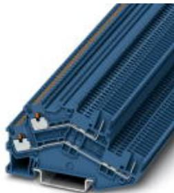
Двухъярусные клеммы, тип подключения: Зажимы Push-in, сечение: 0,14 мм<sup>2</sup> - 1,5 мм<sup>2</sup>, AWG: 26 - 14, ширина: 3,5 мм, цвет: синий, тип монтажа: NS 35/7,5, NS 35/15
