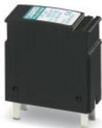
Защитный штекер PT, со схемой защиты для двух 2-проводных сигнальных цепей Ex i без потенциала земли. Номинальное напряжение: 12 В DC. Совместимость с HART.
