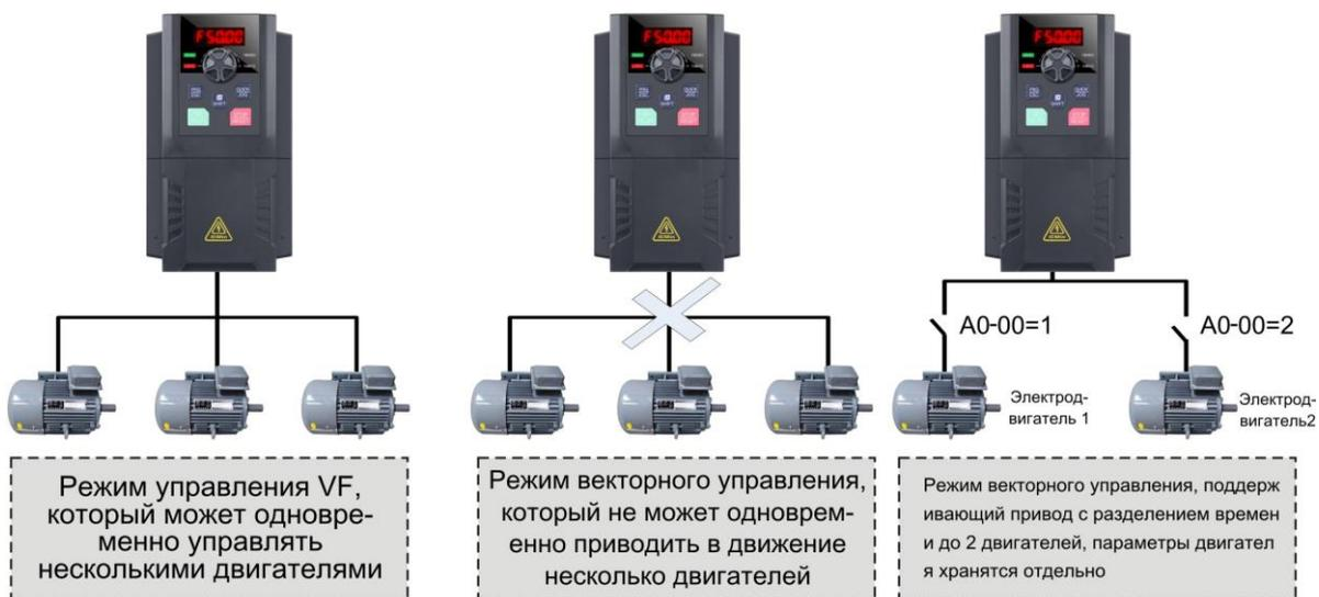
Рисунок 4 - 26 Переключение многоблочных двигателей
