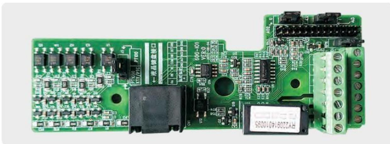
Рисунок 1-1 Внешний вид платы расширения ввода/вывода 1
