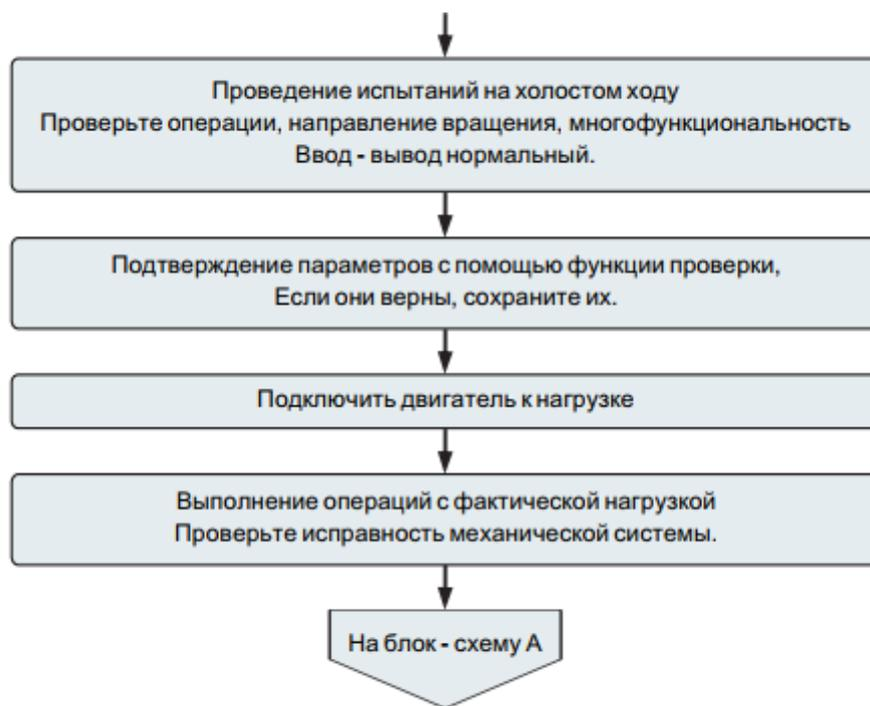
Рисунок 4 - 6 Шаги действия режима управления вектором открытого кольца
