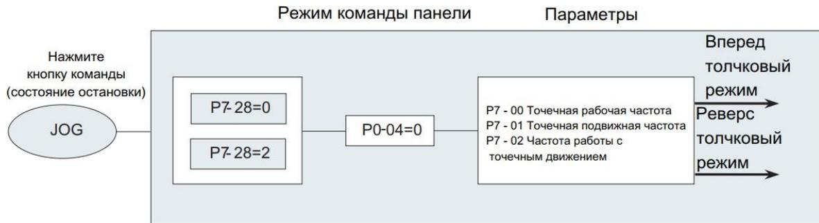
Рисунок 4 - 15 Схема настройки параметров толчкового режима
