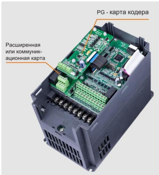
4.0KW - 9.0KW Схема установки
