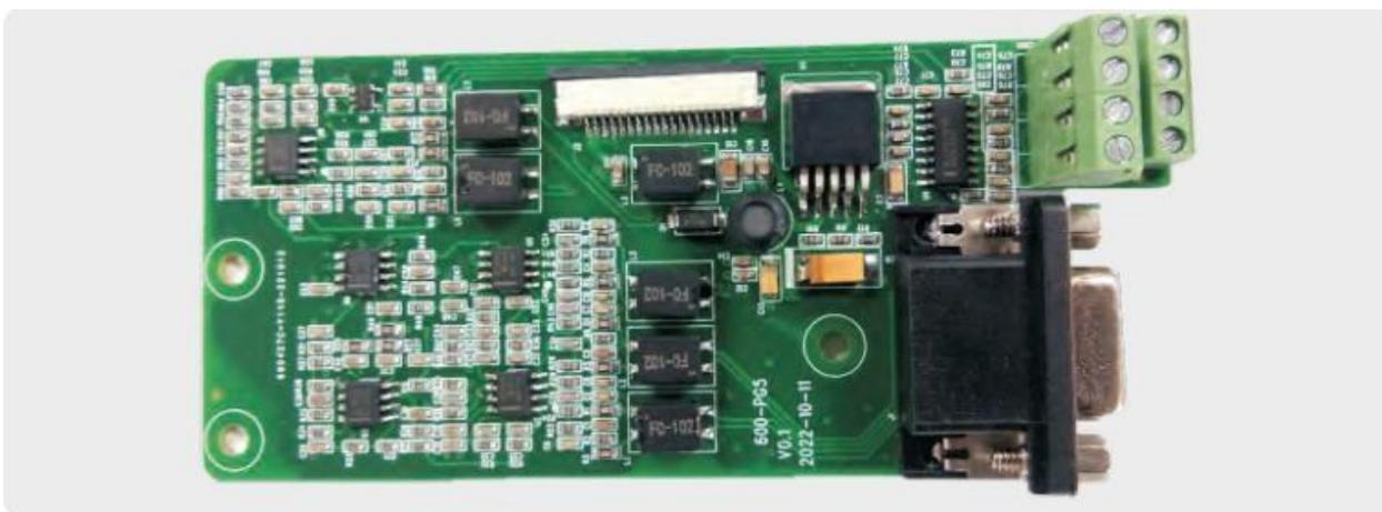
Рисунок 3-9 Внешний вид интерфейсной платы резольвера
