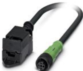
Системный кабель шины, AS-Interface, 2-полюсн., PUR/ПВХ, черный RAL 9005, экранирован., Штекеры прямое AS-i, к гнездо прямое M12, механические ключи: А, длина кабеля: 5 м, с пластмассовой накатанной гайкой
