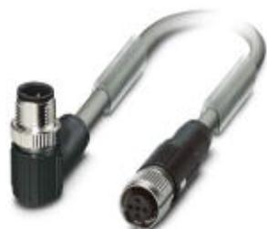
Системный кабель шины, CANopen®, DeviceNet™, 5-полюсн., PUR без галогенов, серебристо-серый RAL 7001, экранирован., Штекеры угловой M12 SPEEDCON, A-кодирование, к Гнездо прямое M12 SPEEDCON, A-кодирование, длина кабеля: 5 м, Соединитель неэкранированный
