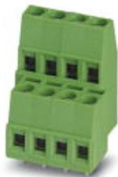
Клеммы для печатной платы, номинальный ток: 17,5 А, номинальное напряжение: 400 В, размер шага: 5 мм, полюсов: 2, тип подключения: Винтовой зажим с натяжной гильзой, монтаж: Пайка волной припоя, направление подключения, проводник/печатная плата: 0°, цвет: зеленый. Возможна установка в ряд модулей с различным количеством полюсов (контактов)!
