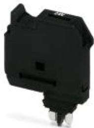
Штекерный держатель предохранителя, тип предохранителя: Наполнен песком, тип подключения: Штекерное подключение, номинальный ток: 6,3 А, номинальное напряжение: 500 В, ширина: 6,2 мм, тип предохранителей: G / 5 x 20, цвет: черный
