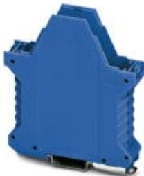
Корпуса для установки на несущую рейку, Высокая конструкция, без вентиляционных отверстий, ширина: 22,6 мм, поперечное соединение: без шинного соединителя, цвет: синий (5015), кол-во контактов поперечного соединителя: не существенно
