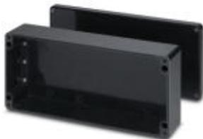
Клеммная коробка, материал: Усиленный стекловолокном полиэфир, с добавлением графита, черный, 160 мм x 260 мм x 91 мм, тип замка: навинчиваемая крышка
