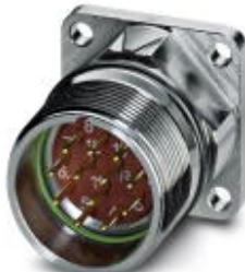
Аппаратн. соединитель, передняя стенка, прямой, Винтовой зажим, M23, полюсов: 17, тип контактов: Штифт, Обжим, Аксиальное уплотнительное кольцо, 4x Ø 3,2, экранирован.: есть
