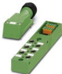
Коробка датчика и исполнительного элемента, применение: Стандартн., тип подключения: Розетка M8 металл, количество гнезд: 6, полюсов: 3, механические ключи: А - стандарт, гнездо для платы: один ряд, индикатор состояния: есть, р-п-р; подключение магистрального кабеля: Пружинные зажимы 180°, экранировка: нет
