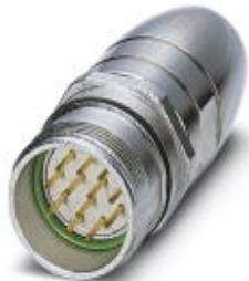
Переходной соединитель, прямой, экранирован.: есть, Винтовой зажим, M23, Полосов: 16+2+PE, тип контактов: Штифт, Обжим, диапазон диаметра кабеля: 3 мм ... 10,5 мм
