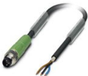
Кабель для датчика / исполнительного элемента, 3-полюсн., PUR без галогенов, темно-серый RAL 7021, экранирован., Штекеры прямое M8, к свободный конец, длина кабеля: 1,5 м
