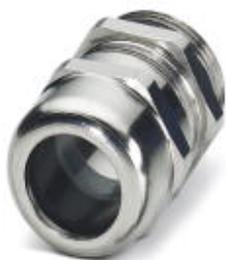
Кабельный ввод, материал резьбового соединения: латунь, никелированный, наружный диаметр кабеля 19 мм ... 28 мм, экранировка: нет, резьба соединительной части: M40 x 1,5, цвет: серебристый, с уплотнительным кольцом
