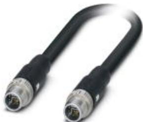
Комбинированный кабель, Ethernet Hybrid CAT5 (100 Мбит/с), 8-полюсн., Штекеры прямое M12 SPEEDCON / IP67, механические ключи: Y, к Штекеры прямое M12 SPEEDCON / IP67, механические ключи: Y, длина кабеля: 15 м, Power with Ethernet (PWE)
